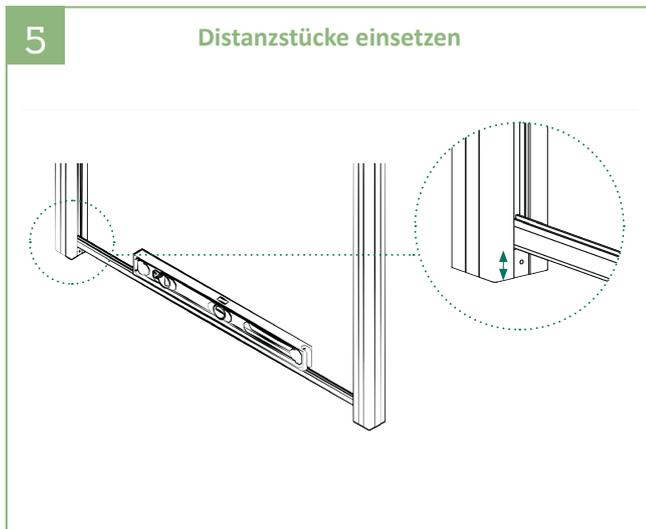
5 | Zuerst auf einer Seite das Distanzstück befestigen. Das Distanzstück der zweiten Seite mit Hilfe der U-Leiste und einer Wasserwaage ausrichten und befestigen.
