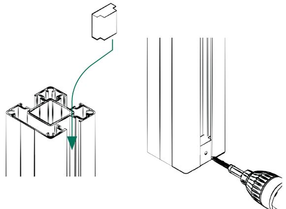
4 | Distanzstück hochkant in die Innenseite der Pfostennut einschieben, bündig mit der Unterkante des Pfostens abschließen, vorbohren und verschrauben.
