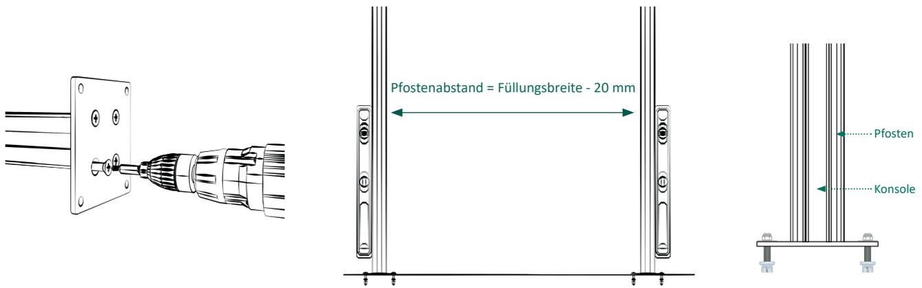
2a | Konsolen auf die Pfosten stecken und mit den mitgelieferten Schrauben von unten fest verschrauben. Ausrichtung der Konsolen bei aufgesteckten Pfosten, danach auf den Untergrund aufdübeln. Die Pfosten schließen nach dem Aufsetzen bündig mit den Konsolen ab.
