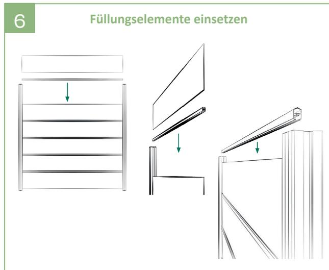
6 | Das U-Profil in die Pfosten von oben einschieben. Danach vorsichtig die Füllungselemente und die H-Profile im Wechsel einsetzen. Mit dem Abschlussprofil abschließen.
