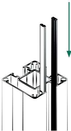
3 | Jeweils zwei der mitgelieferten Bürstendichtungen in die Pfostennuten einschieben.
